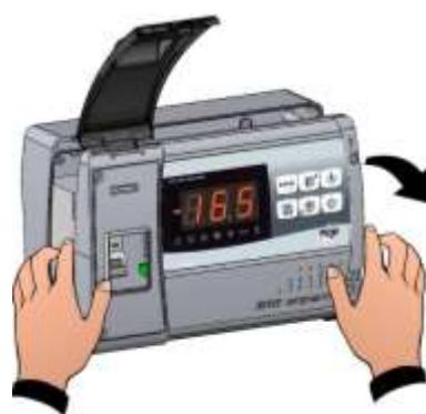
**Abb. 4:** Öffnen Sie die Gehäusefront, indem Sie die beiden Scharniere bis zum Anschlag anheben.
