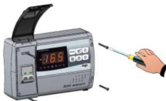
**Abb. 2:** Drehen Sie die 4 Befestigungsschrauben des Gehäuses ab.
