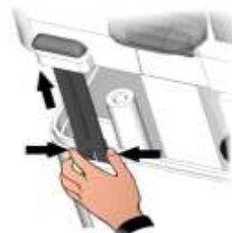
**Abb. 5:** Üben Sie eine Druck auf jede der einzelnen Scharniere aus, um sie aus ihrem Sitz zu lösen und entfernen Sie die gesamte Front.
