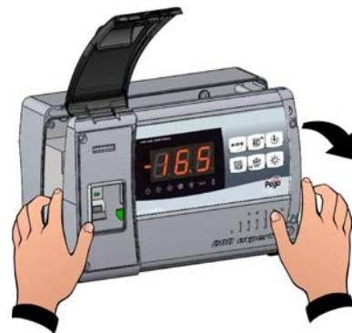
**Abb. 5:** Auf die Seiten der Scharniere drücken und sie aus ihrer Aufnahme ziehen und so den vorderen Teil vollständig abnehmen.
