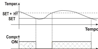
Der Verdichter wird oberhalb des Sollwert SET plus Schalthysterese Hy eingeschaltet und exakt am Sollwert SET wieder abgeschaltet. Siehe Abbildung.
