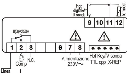
Bei 9-40Vdc, 12Vac/dc, 24Vac/dc, 110Vac und 230Vac: Anschlüsse 7 und 8.
