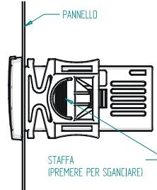
Die Tafelmontageeinheit XR60C sind für einen Ausschnitt 71x29 mm vorgesehen und werden mit zwei Befestigungsbügeln fixiert. Die Befestigungsbügel von hinten aufschieben und durchschieben bis beide Bügel fest einrasten.
