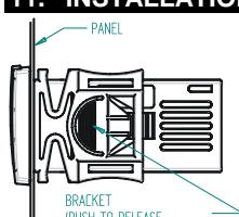
Die Tafelmontageeinheiten XR60C sind für einen Ausschnitt 71x29 mm vorgesehen und werden mit zwei Befestigungsbügeln fixiert. Die Befestigungsbügel von hinten aufschieben und durchschieben bis beide Bügel fest einrasten.
