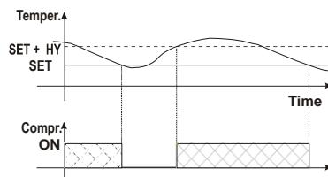
Der Verdichter wird oberhalb des Sollwert SET plus Schalthysterese Hy eingeschaltet und exakt am Sollwert SET wieder abgeschaltet. Siehe Abbildung.
