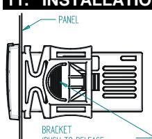
Die Tafeleinbau-Geräte XR60C sind für einen Ausschnitt 71x29 mm vorgesehen und werden mit zwei Befestigungsbügel fixiert. Die Befestigungsbügel von hinten aufschieben und durchschieben bis beide Bügel fest einrasten.
