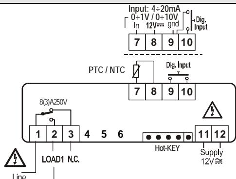
Fühler: Pt100= 7 - 9 (8); Thermoeel. J, K, S = 7(+); 9(-), 12Vac/dc od. 24Vac/cd Hilfsenergie: 11-12
