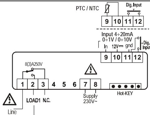
Fühler: Pt100=9 -11 (10); Thermoeel. J, K, S = 9(+) - 11(-), 230Vac Hilfsenergie: 7-8
