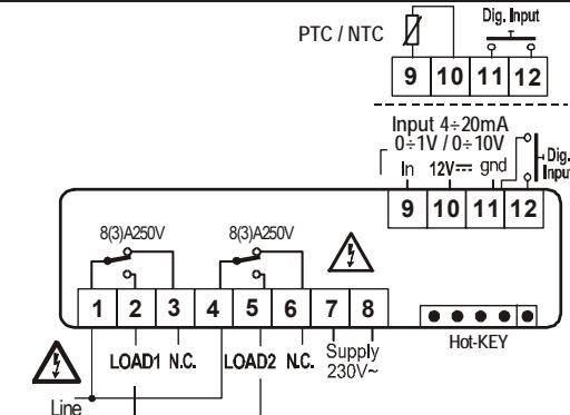
Fühler: Pt100= 9 – 11 (10); Thermoeel. J, K, S = 9(+); 11(-), 230Vac Hilfsenergie: 7-8 HOT-KEY Anschluß auch für XJ485 + CAB/RS1 (Dixell-Aufzeichnungssysteme)
