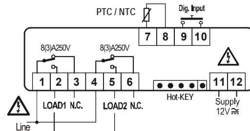
Fühler: Pt100= 7 – 9 (8); Thermoeel. J, K, S = 7(+); 9(-), 12Vac/dc od. 24Vac/dc Hilfsenergie: 11-12 HOT-KEY Anschluß auch für XJ485 + CAB/RS1 (Dixell-Aufzeichnungssysteme)
